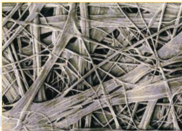
Imagen microscópica de la Lámina Tyvek. Mejora las propiedades de las barreras micropunzonadas de permeabilidad más baja.
